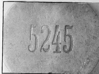
Цифры номера, нанесенные на знак в процессе его изготовления. Равная глубина, четкость, размер и начертание цифр позволяют говорить именно о таком методе их нанесения.
