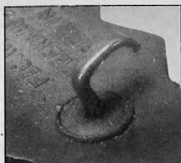
Литые части шарнира на шпанге с проветрым стержнем, на котором вращается специально изогнутая рифленая игла.
