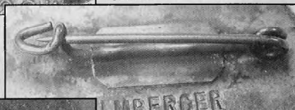
Крепление иглы при помощи пайки без использования флюса. Нет никаких излишков припоя.
