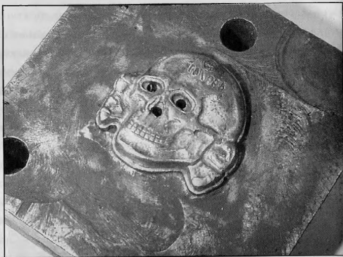
Пуансон штампа с отверстиями для направляющих и клеймом.
