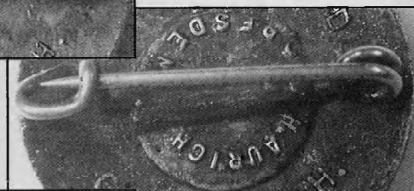
Застежка крепится гладкими, оставленными при штамповке и затем приплюснутыми выступами базового металла.
