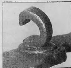
Вариант шарнира на шпанге Люфтваффе в форме шара с прорезью и круглой иглой. Шар запрессован в тело шпанги.
